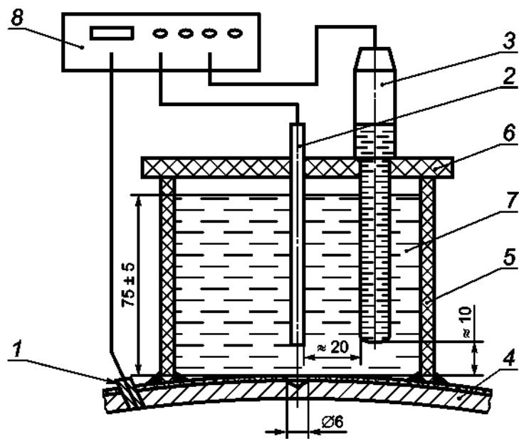
1 — катод; 2 — вспомогательный электрод (инертный анод); 3 — хлорсеребряный насыщенный электрод (электрод сравнения); 4 — карта или пластина с защитным покрытием (испытуемый образец); 5 — цилиндр; 6 — крышка; 7 — электролит; 8 — потенциостат
