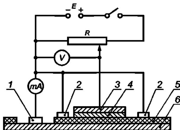
1 — контакт с трубой; 2 — экранирующие кольцевые электроды-бандажи; 3 — кольцевой электрод-бандаж; 4 — тканевое полотенце; 5 — защитное покрытие трубы; 6 — стенка трубы;  $E$  — источник постоянного тока;  $R$  — потенциометр;  $V$  — высокоомный вольтметр;  $mA$  — миллиамперметр
