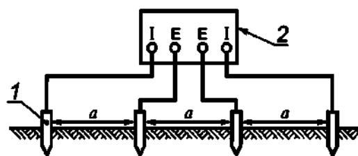
1 — электрод, 2 — прибор с клеммами: I — токовыми; E — измерительными; a — расстояния между электродами (см. формулу (A.1))
