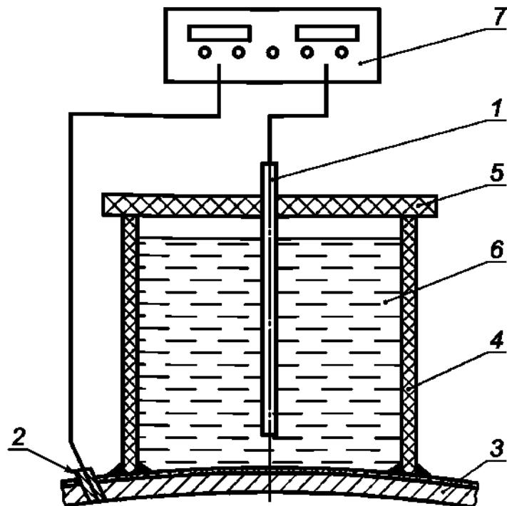
1 — вспомогательный электрод (инертный); 2 — контакт для подачи напряжения на испытуемый образец; 3 — карта или пластина с покрытием (испытуемый образец); 4 — цилиндр; 5 — крышка; 6 — электролит; 7 — омметр или источник постоянного напряжения
