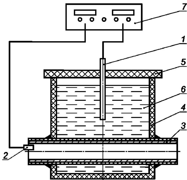
1 — вспомогательный электрод (инертный); 2 — контакт для подачи напряжения на испытуемый образец; 3 — трубка с покрытием (испытуемый образец); 4 — стакан с боковыми отверстиями; 5 — крышка; 6 — электролит; 7 — омметр или источник постоянного напряжения
