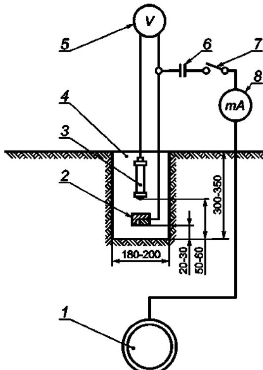
1 — трубопровод; 2 — вспомогательный электрод; 3 — переносной медно-сульфатный электрод сравнения; 4 — шурф;
