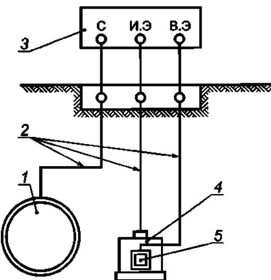
1 — трубопровод; 2 — контрольные проводники; 3 — прибор со встроенным прерывателем тока поляризации датчика с клеммами: С — для подключения сооружения (трубопровода), И.Э — электрода сравнения, В.Э — датчика потенциала; 4 — стационарный медно-сульфатный электрод сравнения; 5 — датчик потенциала
