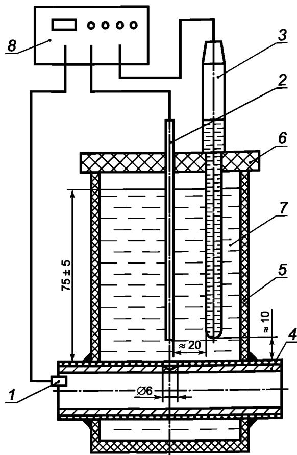
1 — катод; 2 — вспомогательный электрод (инертный анод); 3 — хлорсеребряный насыщенный электрод (электрод сравнения);
