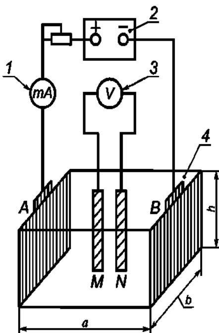
1 — миллиамперметр; 2 — источник тока; 3 — вольтметр; 4 — измерительная ячейка размерами  $a$ ,  $b$ ;  $h$  (см. А.2.2);
