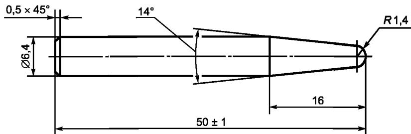
Рисунок Ф.2 — Размеры резца для выполнения прорезания
